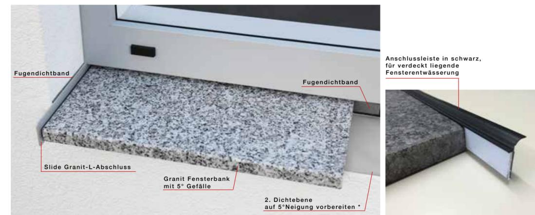
\* Die Fensterbank wird auf der Dichtebene mittels Montagekleber MS verklebt.
